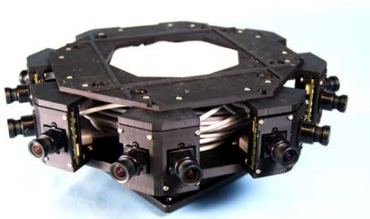
図6 試作した全周囲立体撮像カメラ. Fig. 6 Prototype of the panoramic stereo camera
