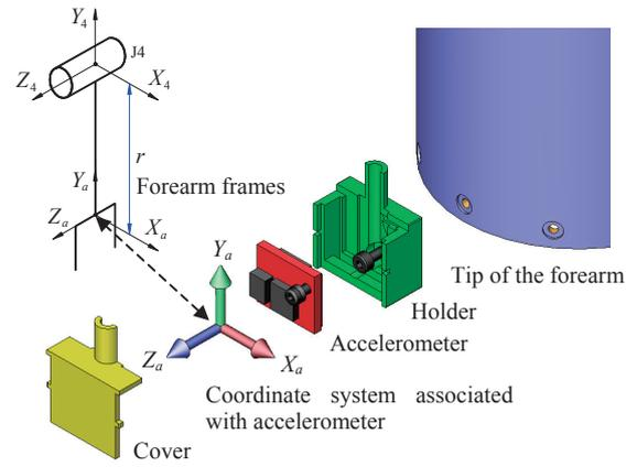
Fig. 7 Accelerometer layout.
